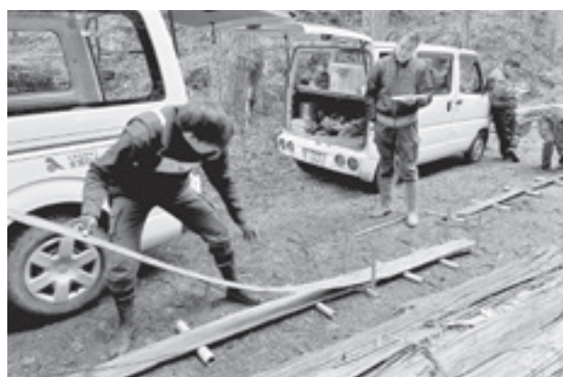
集積した檜皮をワクに積み重ねる
